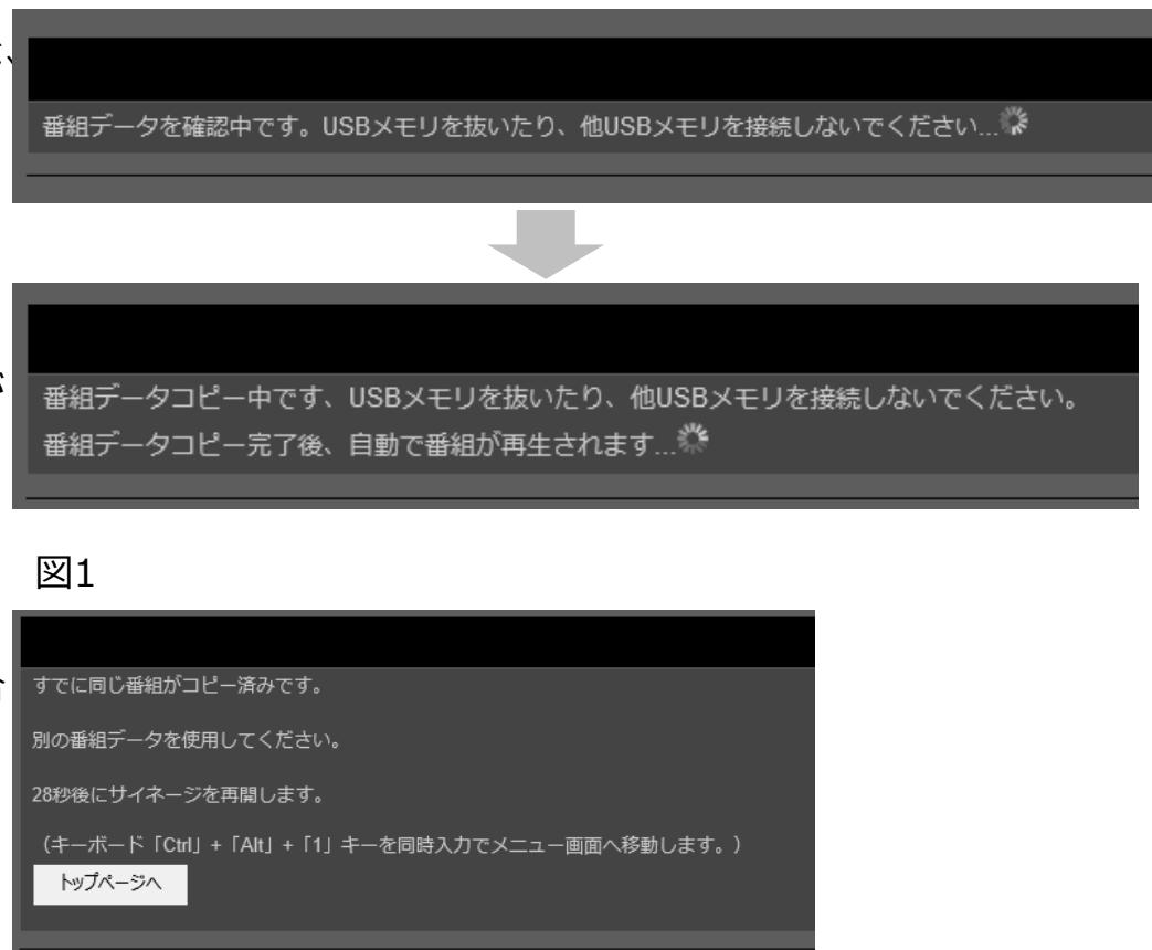
※USBメモリを接続した後、番組データコピーが完了するまで、**絶対にUSBメモリを抜いたり、他USBメモリを接続しないでください。**
